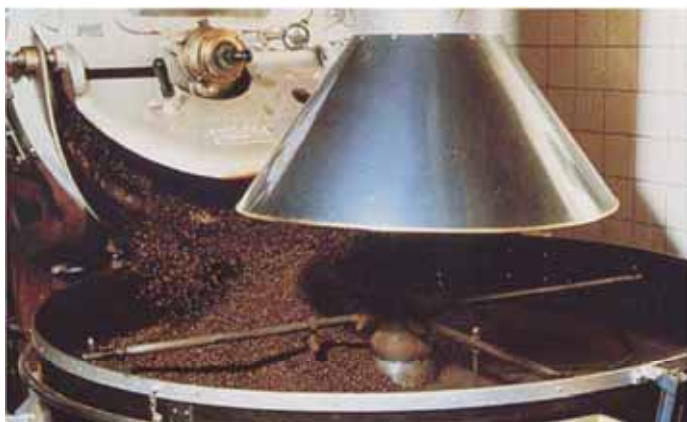
Tambour de torréfaction / tamis de refroidissement
